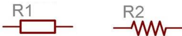
รูปที่ 2.1 สัญลักษณ์ของตัวต้านทานใช้ได้ 2 แบบ
